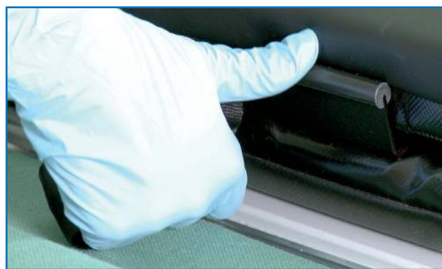
Zum „Entriegeln“ der Oberauflage Seitenfixierungen an der Unterauflage einseitig nach unten drücken
