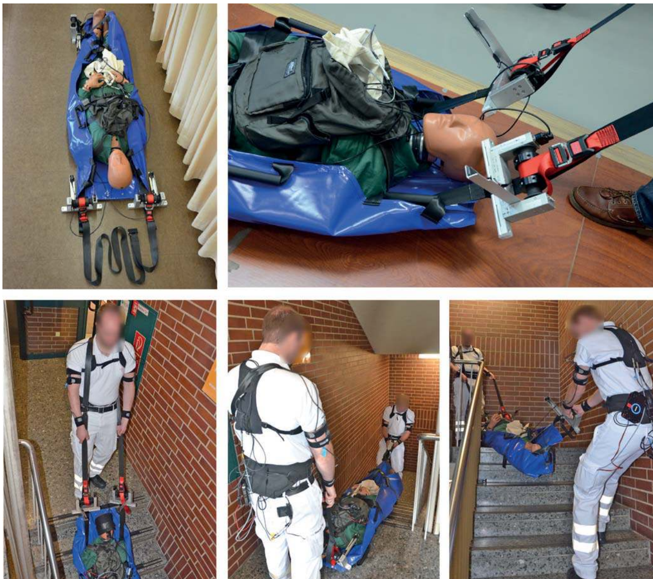
Abbildung 2.6: Treppengleittuch mit Dummy und Messtechnik im Einsatz
