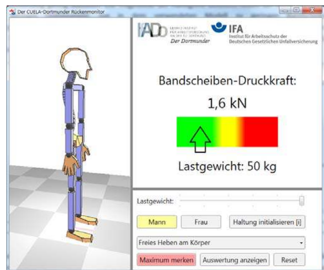
Abbildung 4.4: Simulierte Bandscheiben-Druckkraft im aufrechten Stand mit 10° Rumpfvorneigung und 10° Armneigung bei einem Lastgewicht von 50 kg, beidhändig gehalten
