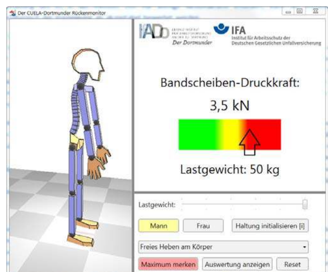
Abbildung 4.4: Simulierte Bandscheiben-Druckkraft im aufrechten Stand mit 10° Rumpfvorneigung und 10° Armneigung bei einem Lastgewicht von 50 kg, beidhändig gehalten
